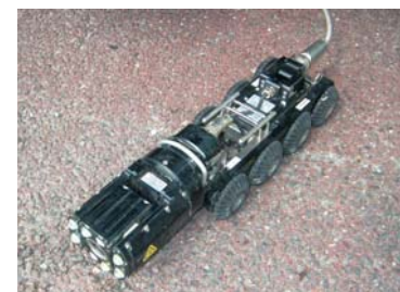
下水道管渠内に「本管用テレビカメラ搭載車」を走らせ、管渠の状態を探る。
