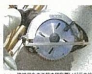
✗ 浜削用丸のこ盤の移動開いが元の位置に自動的に戻らないものを使用している。
