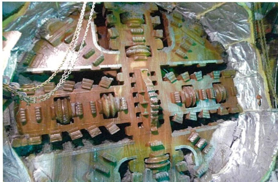
マシンの全景。至る所で見られる摩耗した刃先が、地盤の固さと難工事を物語る。
