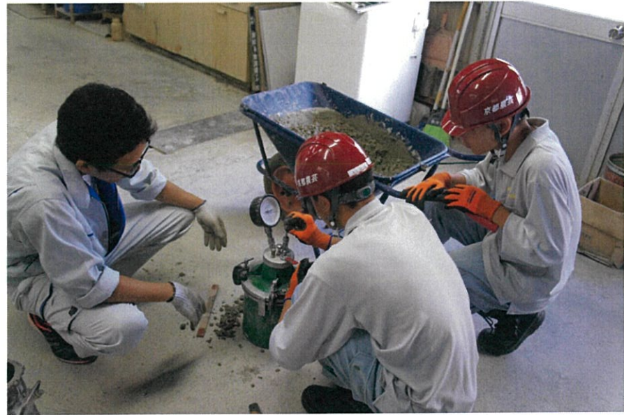
セメントの実験中。品質検査の重要項目「空気量」をエアメーターで把握する。
