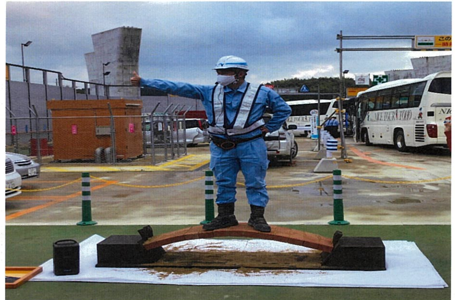
橋の原理を伝えるレンガと土の模型。今回、初お披露目にして初実験だった。
